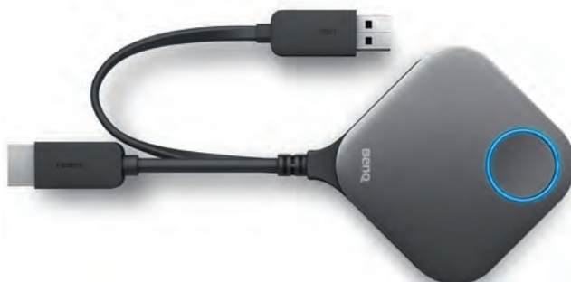
Doppelter Anschluss: Dem HDMI-Funkadapter von Benq dient ein USB-Stecker zur Stromversorgung.
